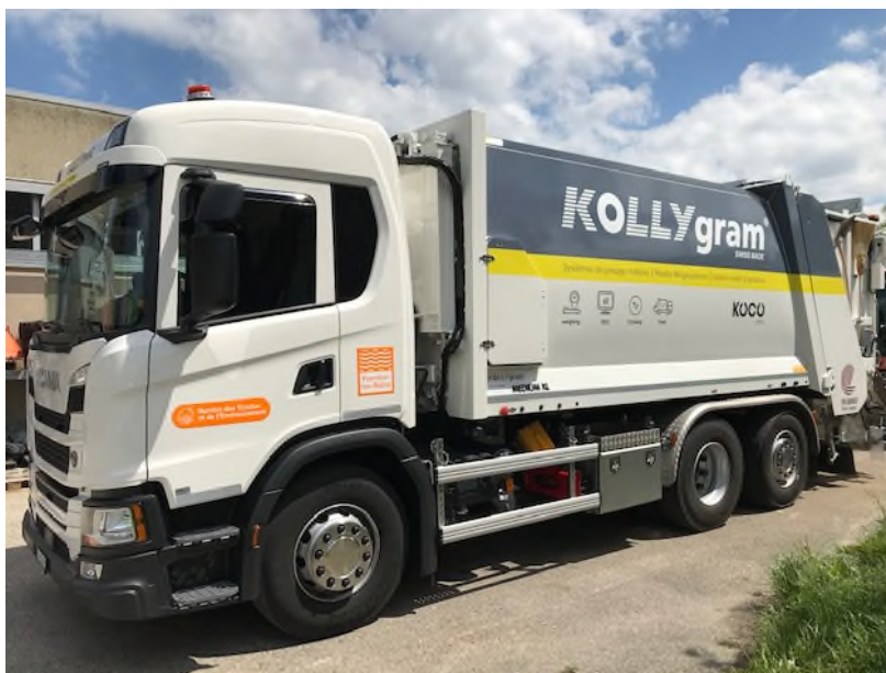
Camion BOM testé par la Municipalité en 2019. Le système est à chargement arrière.
